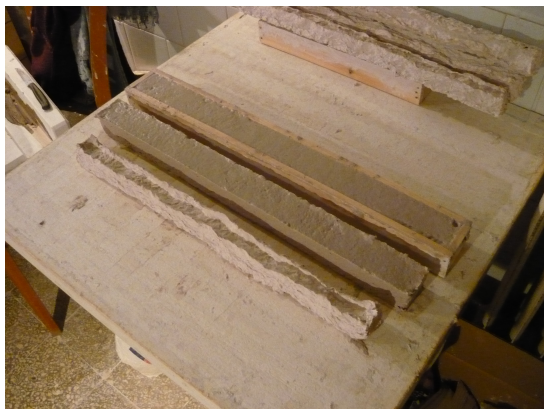
78. ábra Porcelán rúd öntésének folyamata: egy száraz, egy frissen öntött rúd illetve a nyers massa az öntőkeretben.
